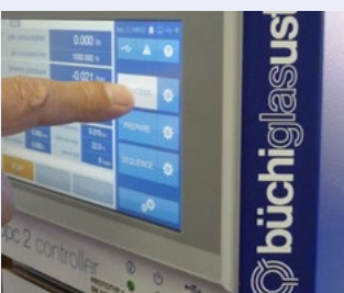
Setting of leak testing parameters / Einstellung der Parameter der Dichtheitsprüfung
